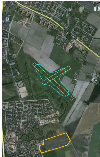
Figur 4 FBN nivåer: Röd: 60dBA, grön: 55dBA blå: 50dBA. Område för planerade bostäder markerat med orange linje. Källa: Bullerutredning, Vectura 2013.
