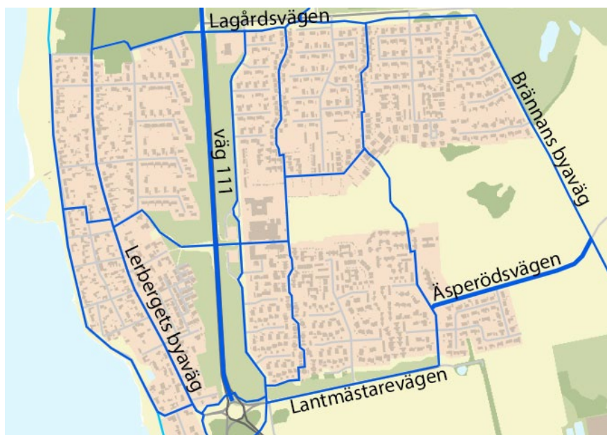
Bild: Utdrag ur ÖP 2035. Vägledning och förslag till utveckling av huvudnät för gång- och cykel. Bred blå linje föreslår ändrad gång- och cykelvägnät längs med Äsperödsvägen.
