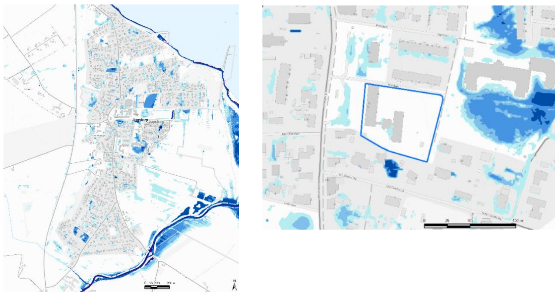
Figur 5-3. Kartorna visar områden som kan bli utsatta för översvämning vid skyfall (beräknade maximala vattendjup i meter i samband med ett framtida 100-årsregn med klimatfaktor 1.3.). Till höger visas en inzoomning av centrumområdet som planeras för bebyggelse. I mörkblå områden kan vattendjup stiga till nära en meter.
