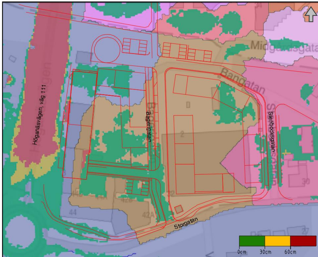
Figur 8: Översvämning inom planområdet vid ett mindre regn än då vatten från väg 111 stiger upp på planområdet.
