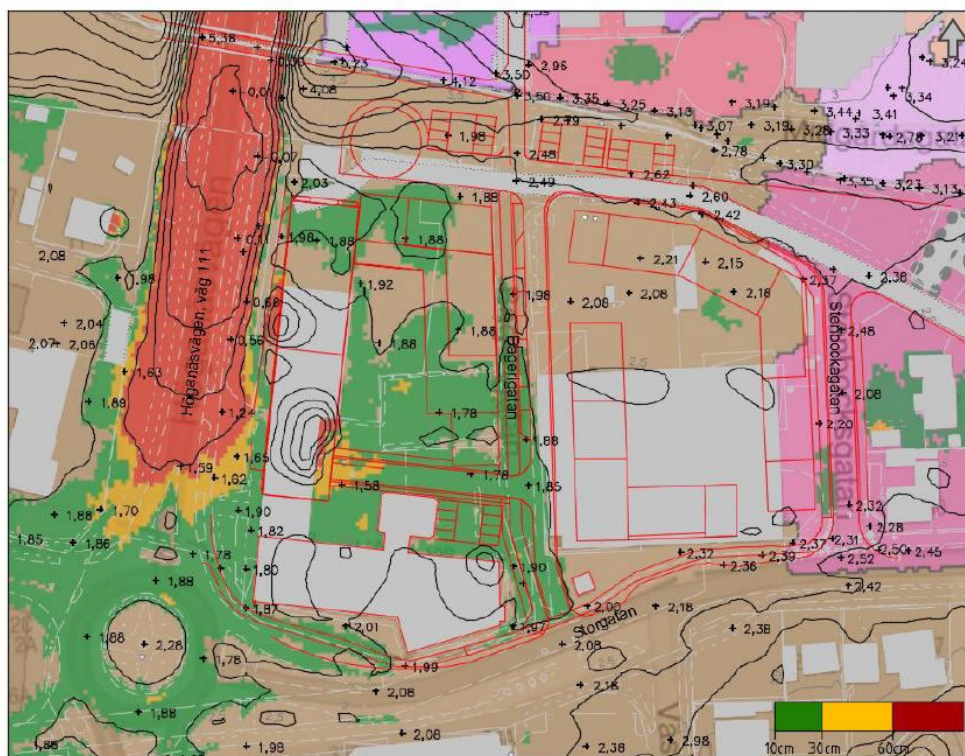
Kartbilden visar översvämningssutbredning inom planområdet vid skyfall med 100-årsregn med varaktighet 6 timmar och klimatafaktor 1,25.
